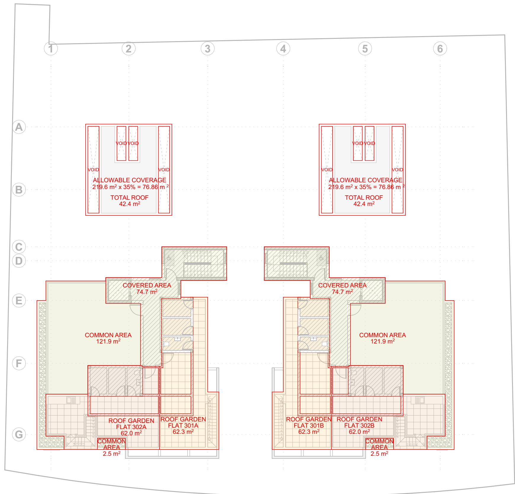
ROOF GARDEN ΕΜΒΑΔΟΜΕΤΡΗΣΗ - ΚΛΙΜΑΚΑ 1:200
